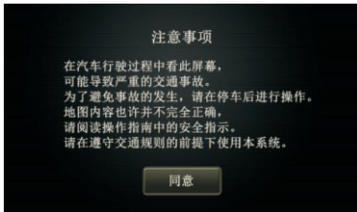
按下(同意)按钮,进入上次关机时的界面。将ACC调至OFF(关闭引擎),则电源关闭,本机自动保存当前的页面,下次开机时将进入该页面。
